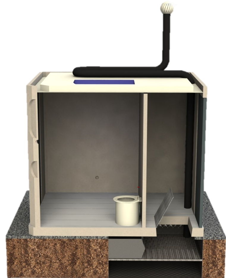
Ventilation naturelle par cheminée solaire/éolienne
